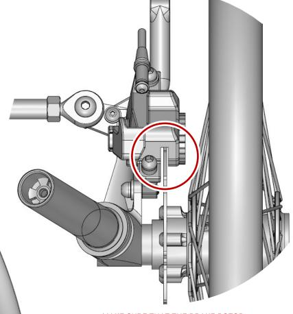
MAKE SURE THAT THE BRAKE ROTOR GOES IN THE CALIPER OPENING WHEN INSTALLING THE WHEEL.
