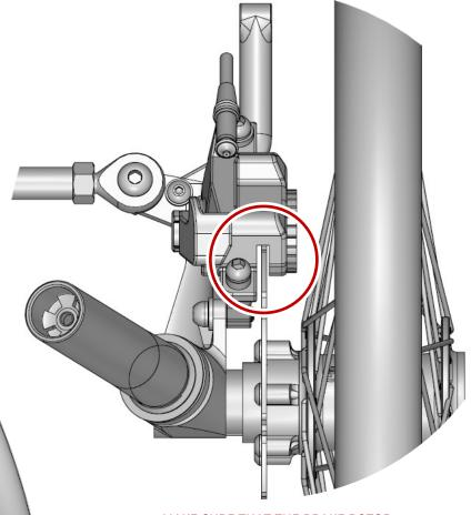
MAKE SURE THAT THE BRAKE ROTOR GOES IN THE CALIPER OPENING WHEN INSTALLING THE WHEEL.
